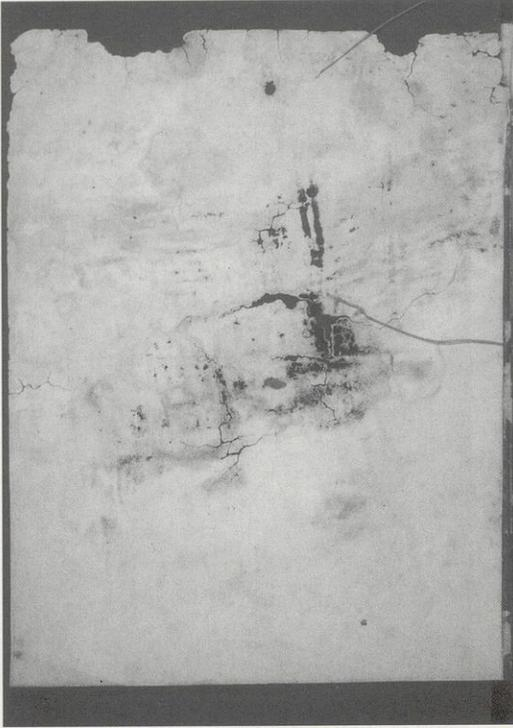
Abb. 3: Verfärbungen und Substanzverlust durch Schimmel
